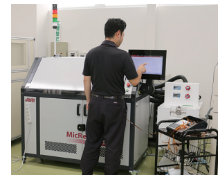
パワーサイクル試験装置
