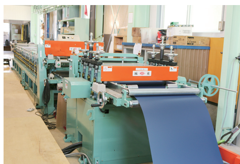
今回導入した嵌合立平葺屋根の加工ライン
