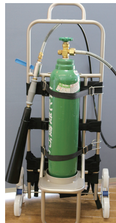
開発したキャリアスタイルのドライアイス噴霧機
