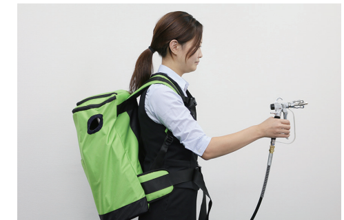
改良を重ね、扱いやすいようにバックに入れて背負えるようにした噴霧器
