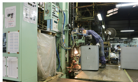
導入したシーム溶接機を使用して行われている溶接作業
