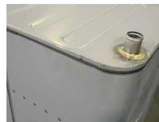
シーム溶接実施部
