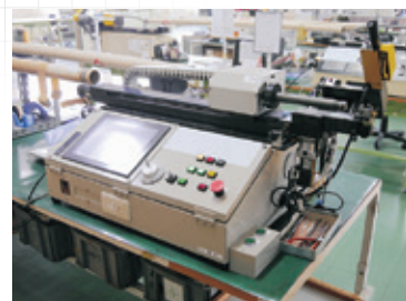
宇宙用同軸ケーブルアセンブリの開発を可能にしたケーブル曲げ機
