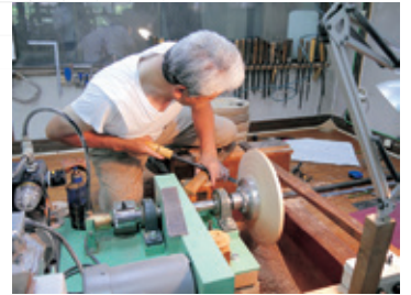
真空吸着式ろくろを使った加工
