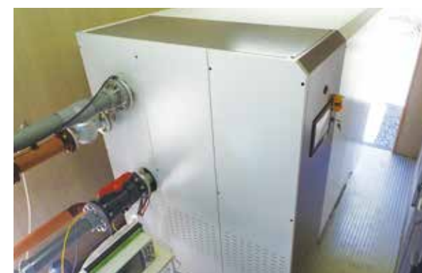
今回開発した小型バイナリー発電 IoT システム
