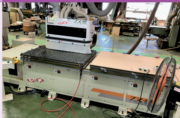
本事業により導入した複合ボーリングマシン
