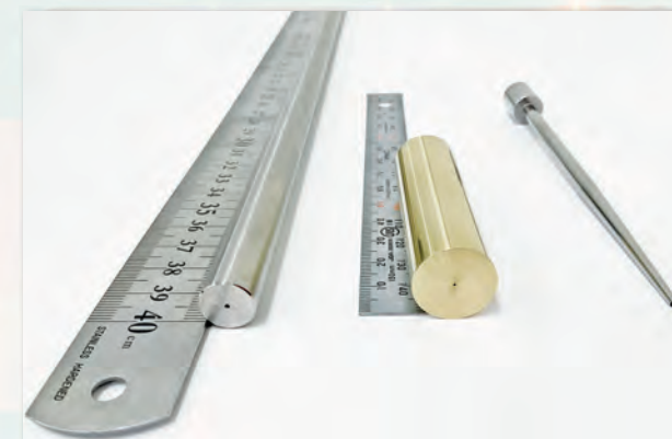
世界最小ガンドリル 径0.5mm 深さ60mm 径1.0mm 深さ40mm 切削加工の概念を覆す深孔加工
