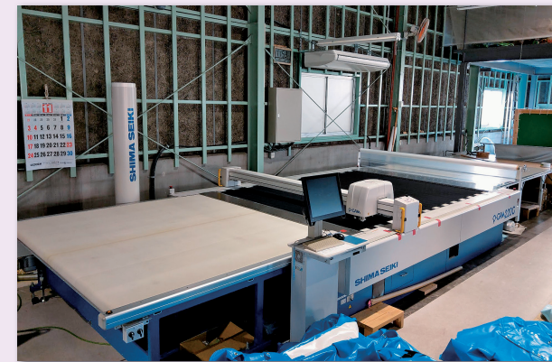
導入した自動裁断機はエアで生地を送る
