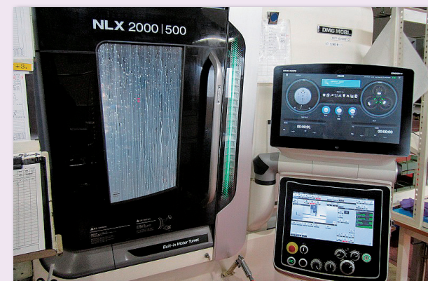
複数工程を複合機がワンチャックで加工
