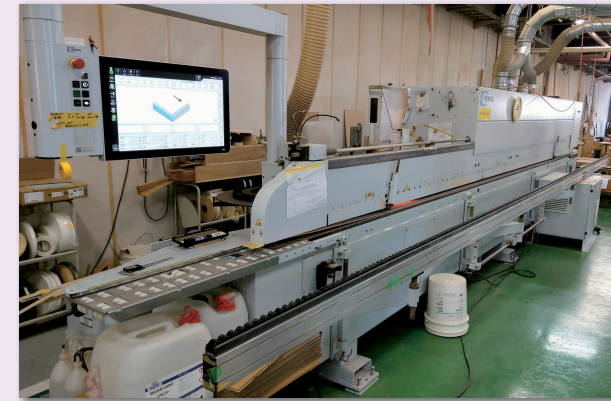
新しい縁張機により生産性は向上
