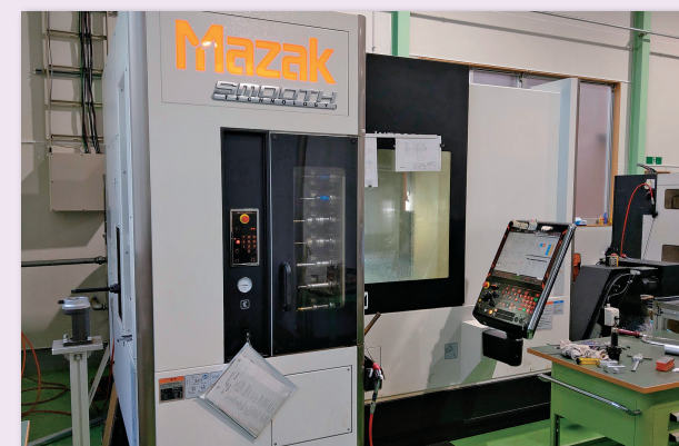
大型マシニングセンターは複合加工が可能となった
