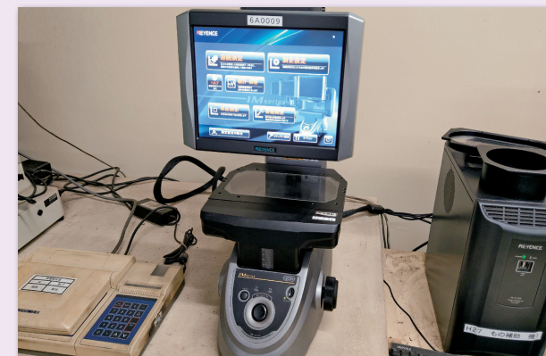
画像寸法測定器は投影した部品を瞬時に測定し品質を保証する
