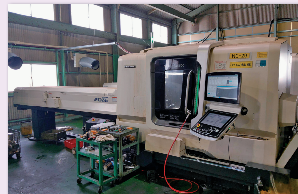
導入されたCNC旋盤はバーフィードによって材料が自動投入される
