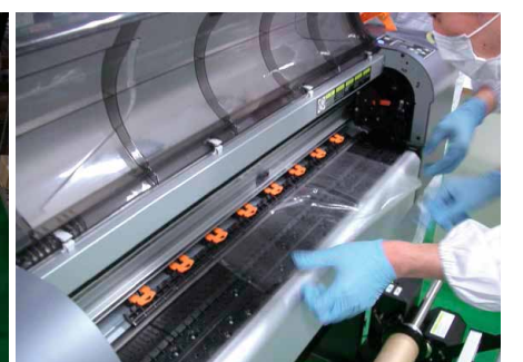
専用オブラートの厚みは20 μm
