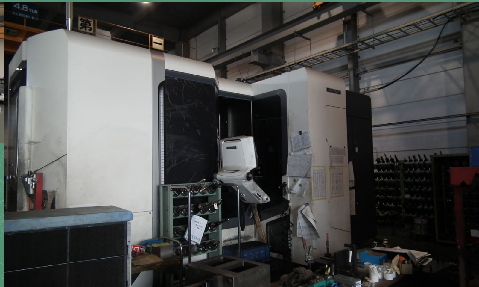
■ 主軸回転数が最大1万5000回転の横型MCを導入。アルミ加工への挑戦に大きく貢献した
