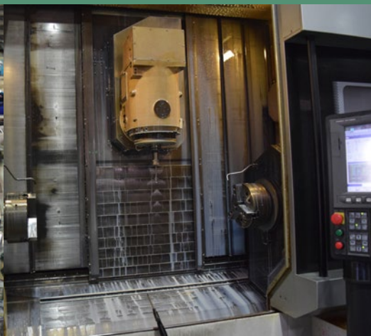
■ 一方の主軸で旋盤加工、もう一方でMC加工を行う
