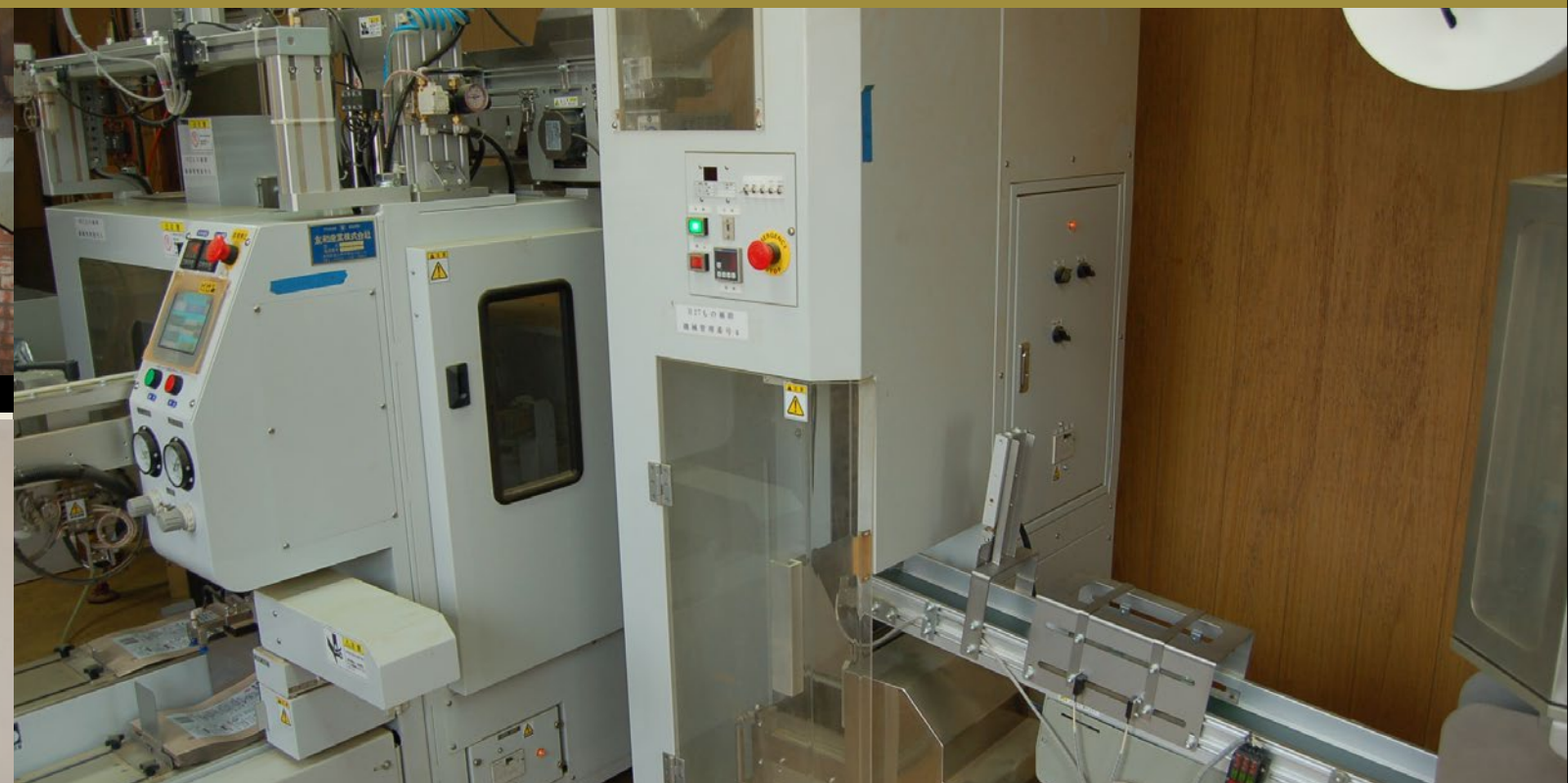
補助金で導入した設備。リーフタイプの茶葉を一定量ティーバッグに詰める
