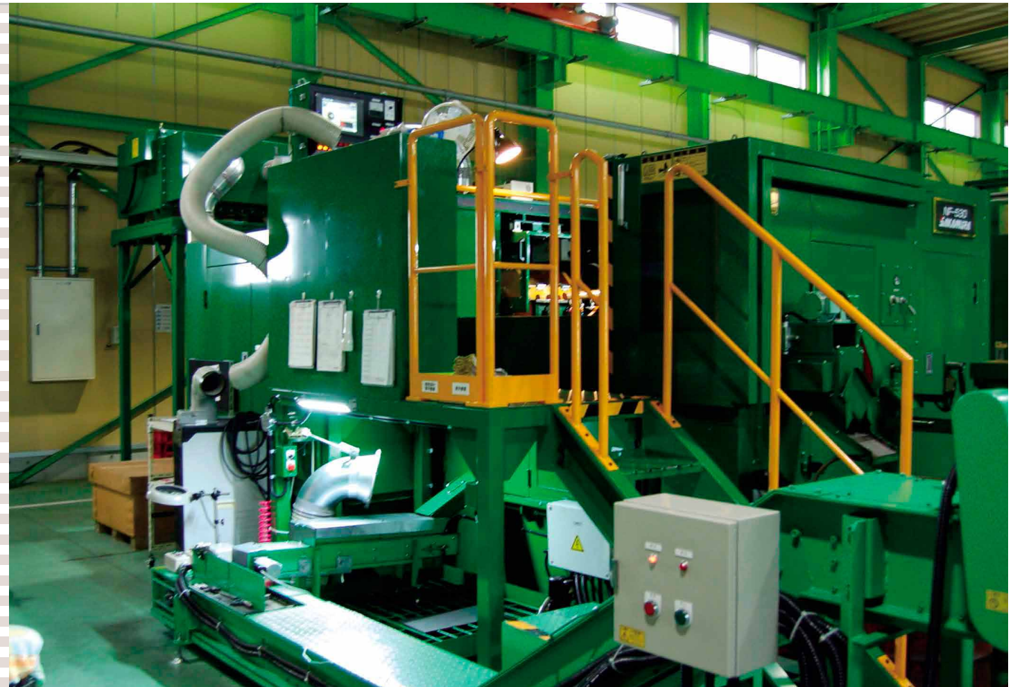
導入した最新型のフォーマー（多段式鍛造機）。アルミニウム製ナットの試作を繰り返した
