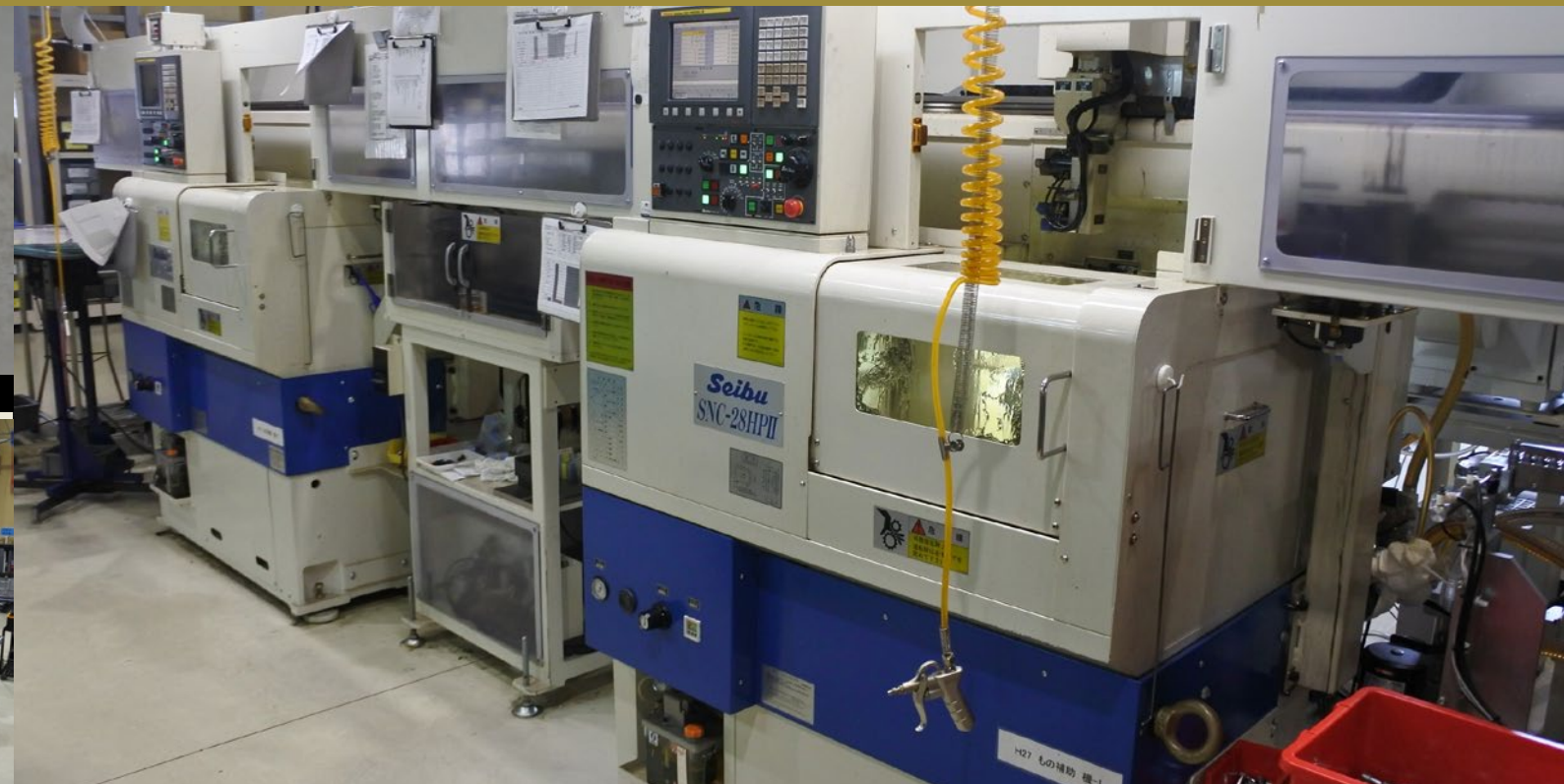
補助金で導入した西部電機の旋盤2台。ポベットの高精度旋削を実現した
