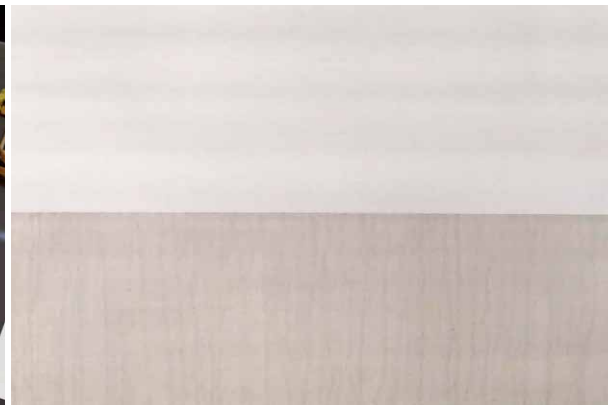
アルミ板上での暴露試験（上がガラスコーティング施工面）
