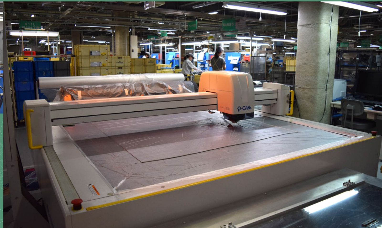
■ 設計データを入力すれば、NC裁断機が自動で皮革パーツをカット。寸法の微調整も容易に行える
