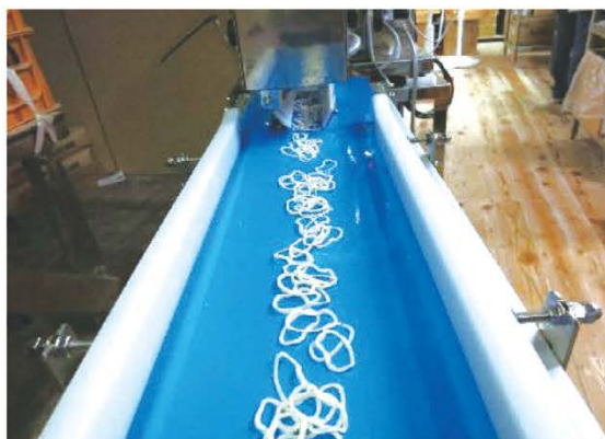
試験稼働の実施（輪状型の麺が出てくるところ）
