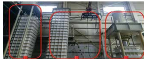
初日の自然垂れの後、軽い油圧で圧搾
