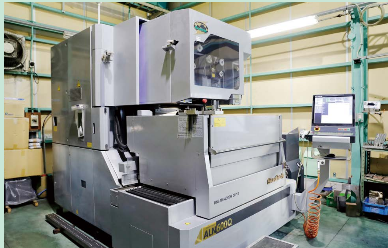
①導入設備名／精密ワイヤ放電加工機ALN600Q型 特徴／導電性の硬質材の精密加工が可能
