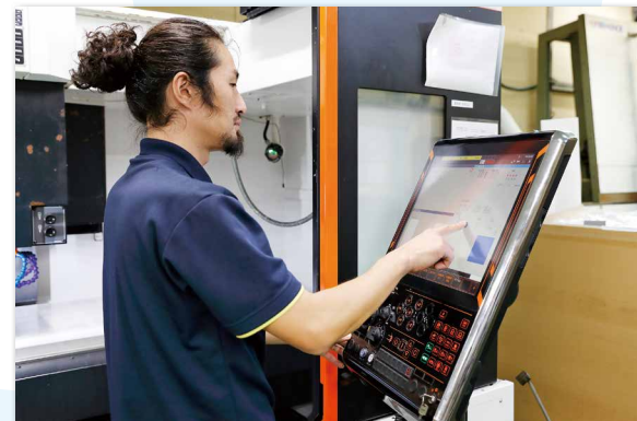
立形マシニングセンタ： タッチパネルでパラメーターを素早く入力
