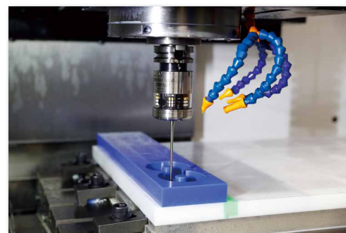
自動検査センサー（タッチプローブ）： マシニングセンタに取付け、加工素材にセンサーが接 触して形状を測定
