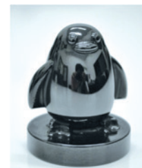
図1. 5軸加工の試作品 ペンギンの置物であるが、 切削では、かなり高度な技 術が必要な加工である。
