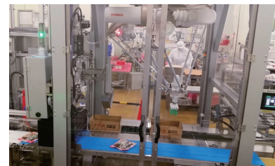
パラレルリンク型ロボットを搭載したFA装置例
