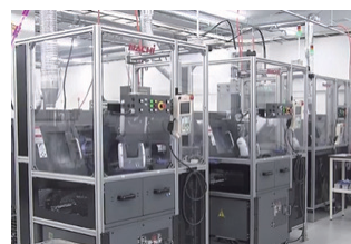
ロボット化した切削工程 （旋盤4台はコンベヤで連続処理）
