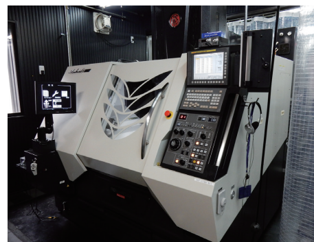
超高精細微細加工機Android II type-s
