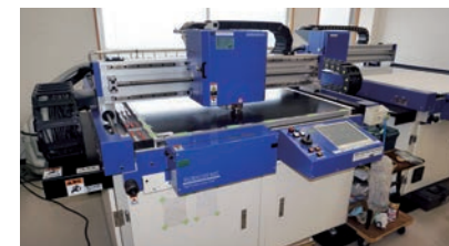
木型の離型を製作する面版加工機
