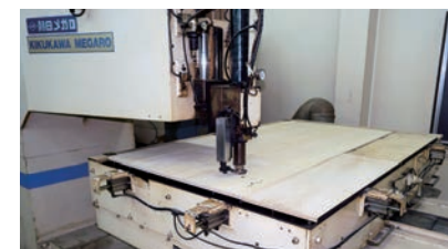
木型を加工するレーザー加工機
