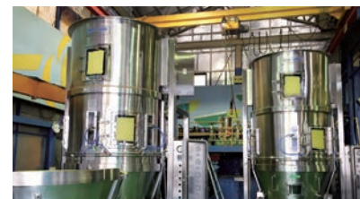
シートメタルの曲げと溶接加工などで生み出した装置類
