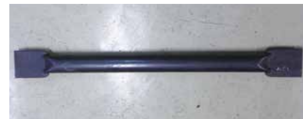
【プレス1工程で製造したパイプ梁】
