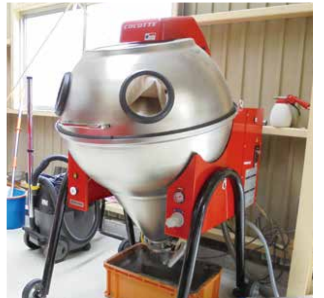
【磨き工程の内製化を実現したウエット・ブラスト装置】
