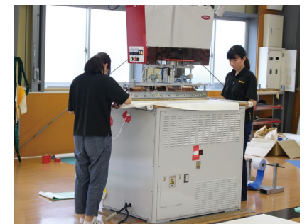
天井吊式ハイブリッド高周波ウェルダージの導入により焼きつきが飛躍的に改善された。
