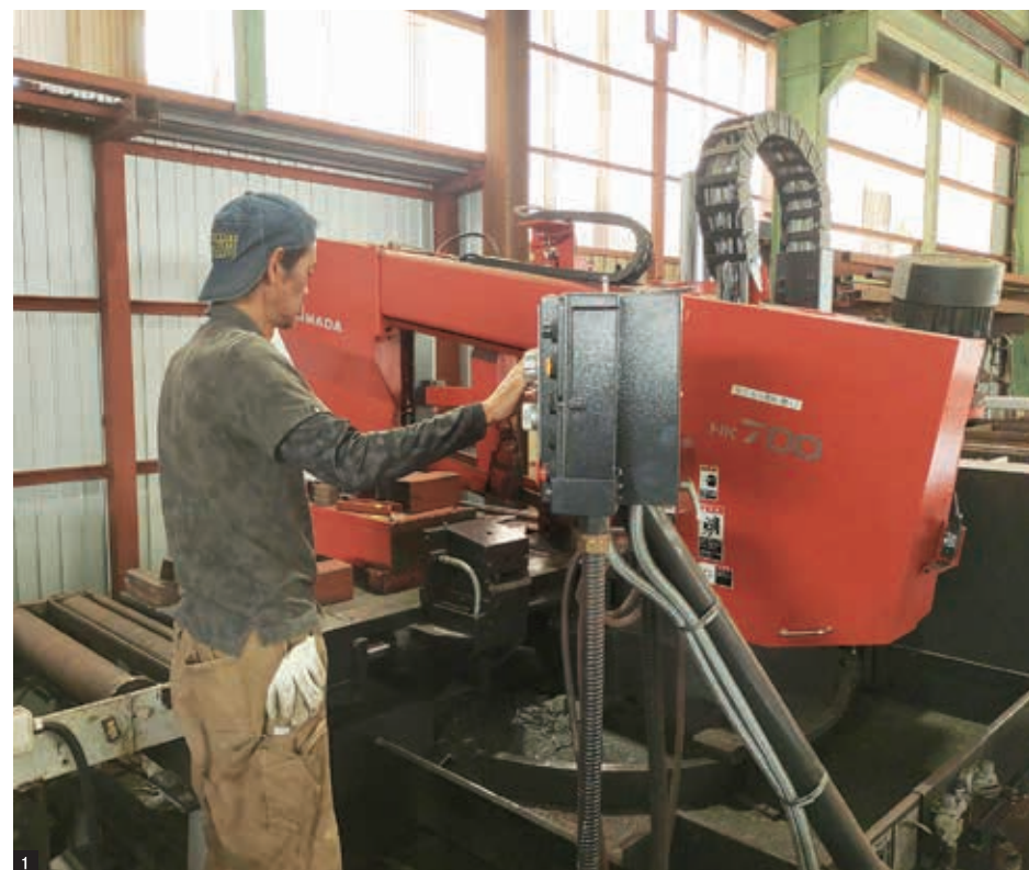
1 導入した形鋼バンドソー 2 工場内の様子(溶接作業) 3 鉄骨建築専用の3DCADで図面を作成するスタッフ
