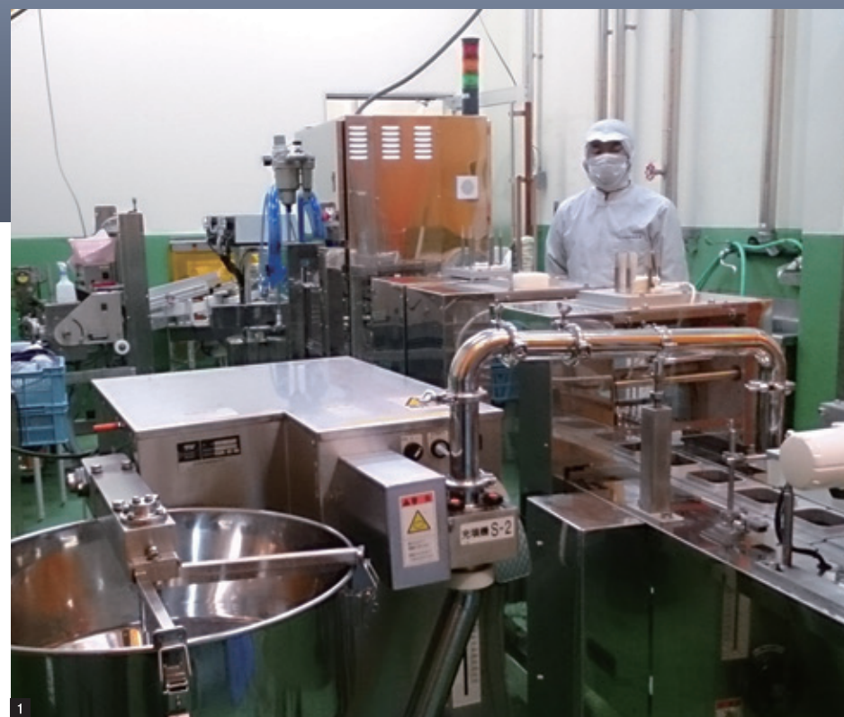
1 今回導入した全自動定量充填包装可能な味噌500g(300g)充填トップシール機 2 有機味噌商品 3 野菜、加工食品
