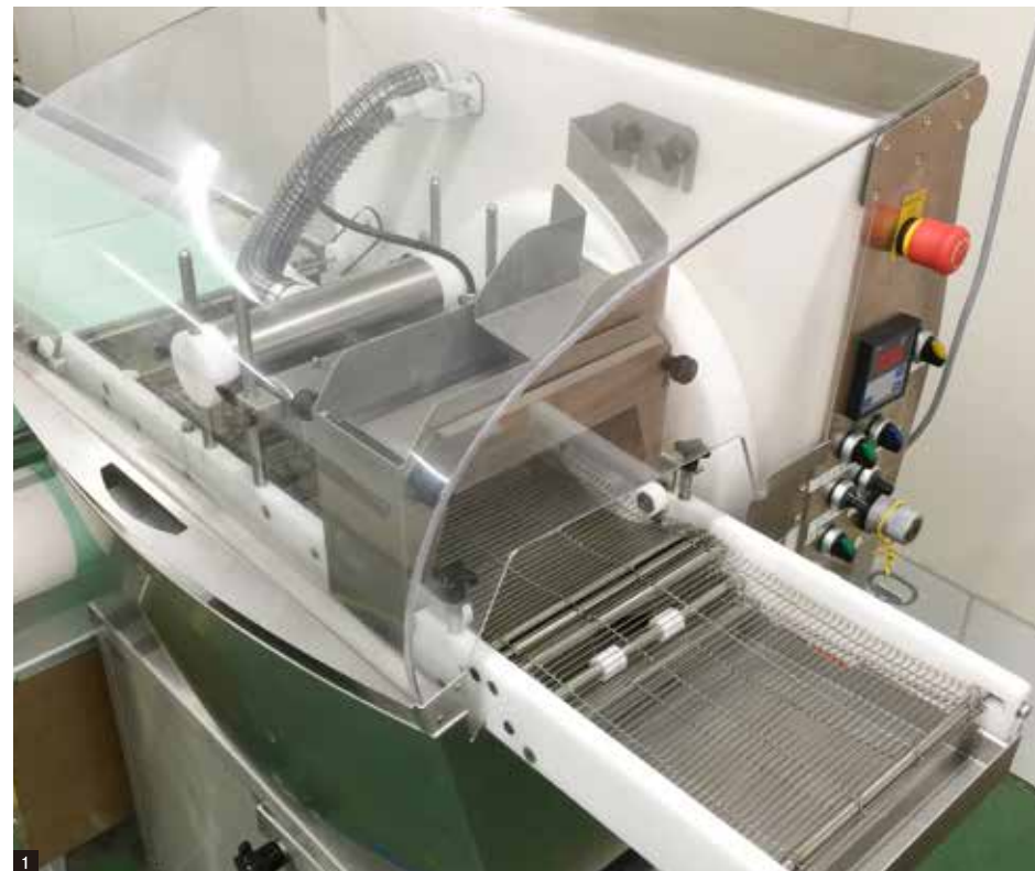
1,2,3 チョコレートエンローバー&モールディングマシーン式 4 1分間で最大250個を包装できるピロー包装機
