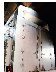
本事業で導入した小型乾燥炉
