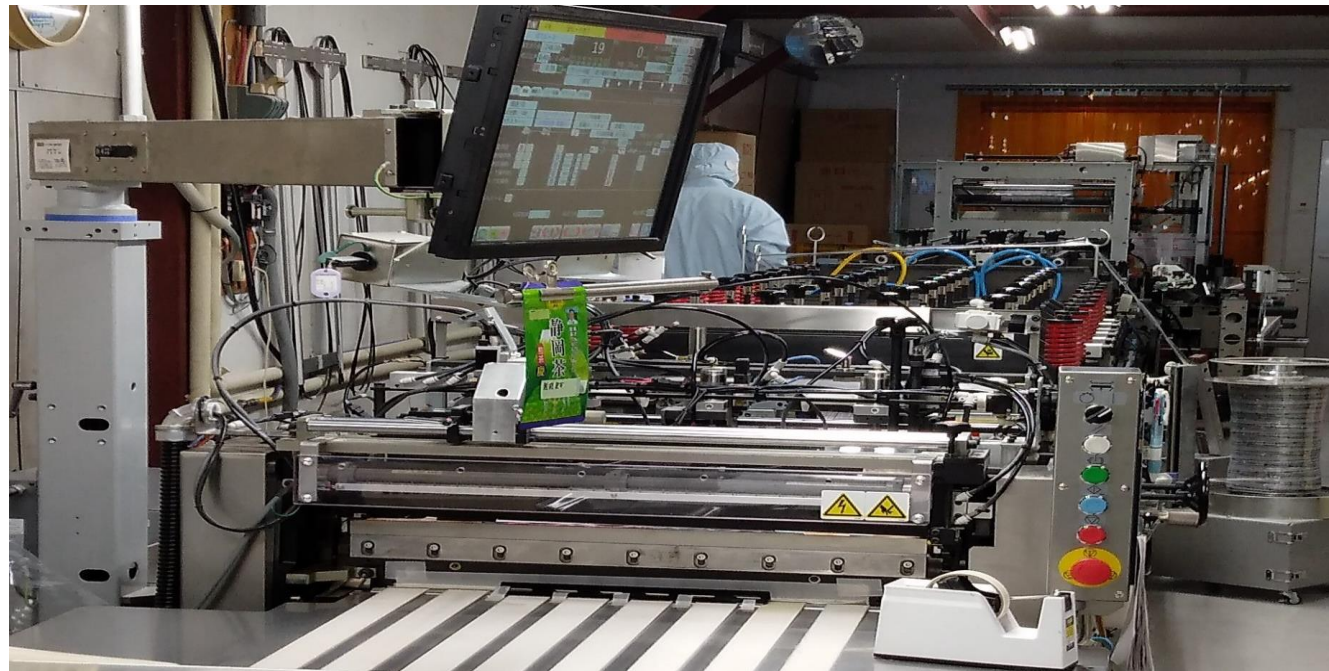
高速三方・チャック兼用自動製袋機
