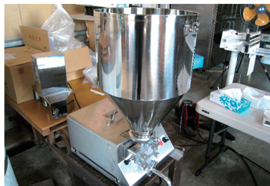
導入設備：パズル充填機
