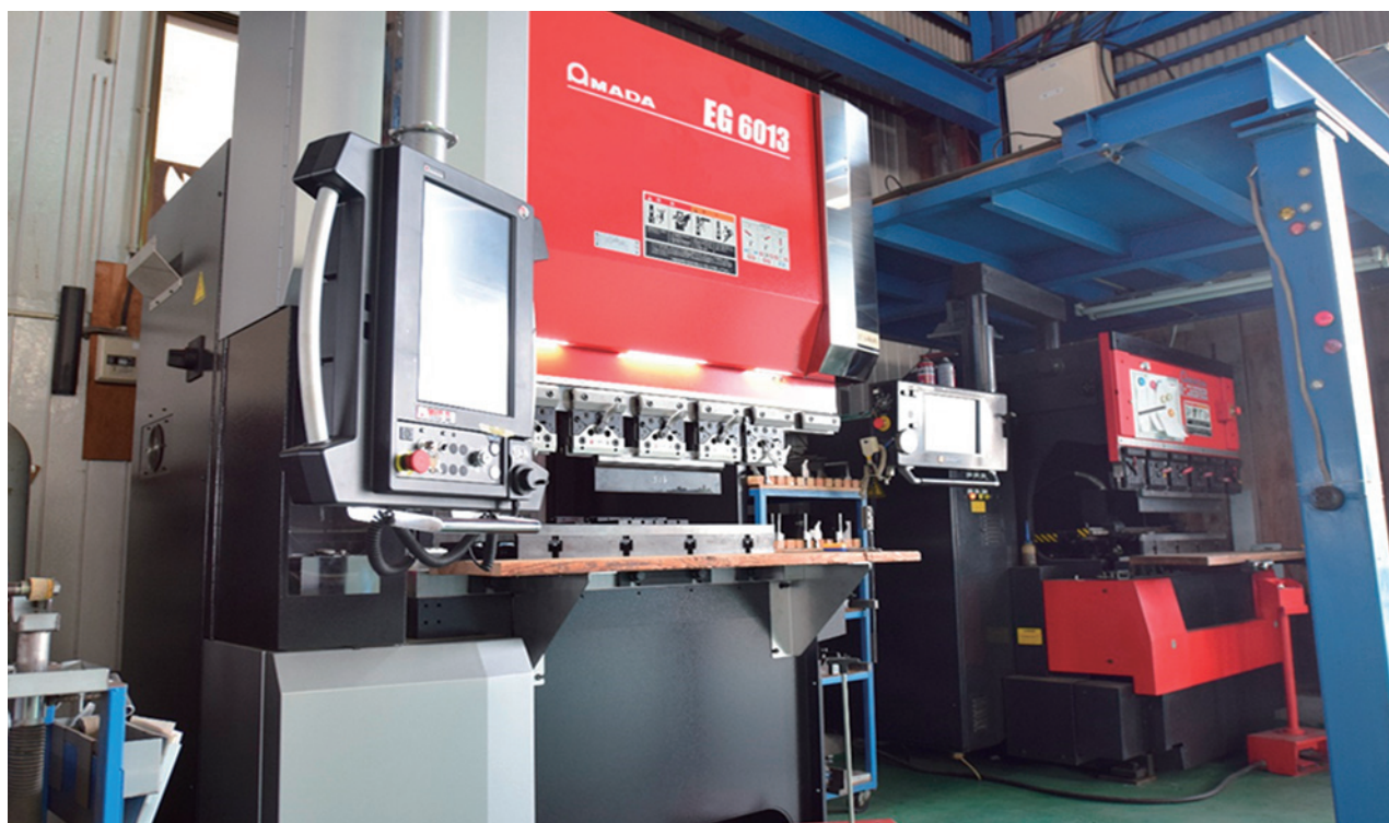
導入機：サーボモーター駆動の最新式ベンディングマシン
