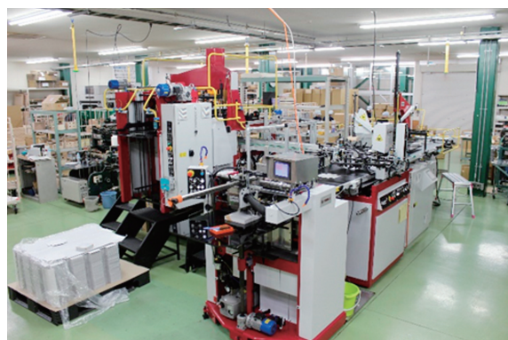
導入設備：全自動貼り箱製造機
