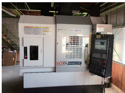
導入設備：高精度3軸立型マシニングセンタ
