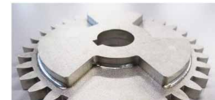
カムギア 部品をレーザーで切出し、レーザー溶接。
