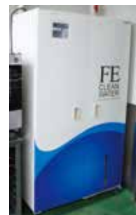
▲電解次亜水生成装置
