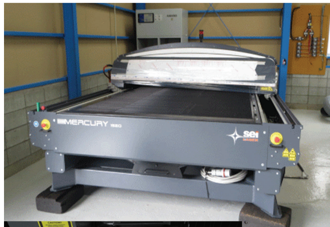
新しく導入したレーザー加工機。1500×2000 の大型の加工まで可能。
