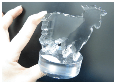
▲アクリル加工機で切り抜いたヒツジ。切り抜いた後の補取などの作業が削減できた。
