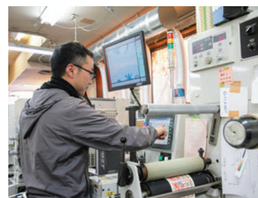
UV印刷機の導入で、フルカラーのシール印刷も社内で対応可能になった
