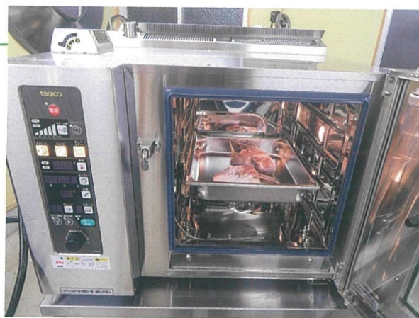
【導入したスチームコンベクションオーブン】
