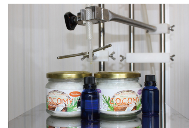
▲「パズル式充填機」では大小さまざまな充填に対応できる
